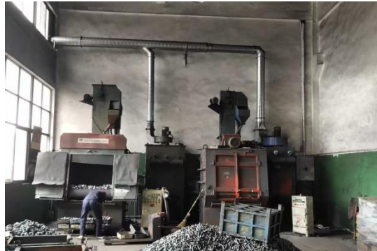
抛砂废气处理设施
