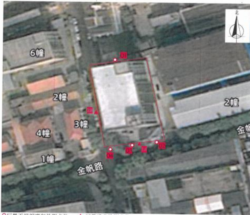
○厂界无组织废气检测点位 ▲厂界噪声检测点位 厂界无组织废气、厂界噪声检测点位图
