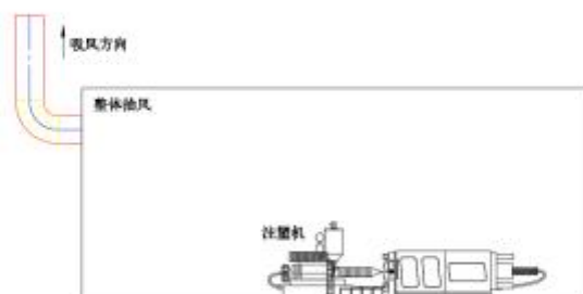
图 3-1 注塑废气前端收集示意图
