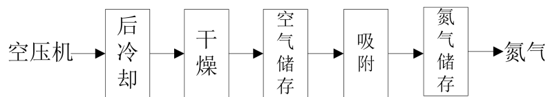
图 2-6 项目碳分子筛制氮工艺流程及产污环节图
